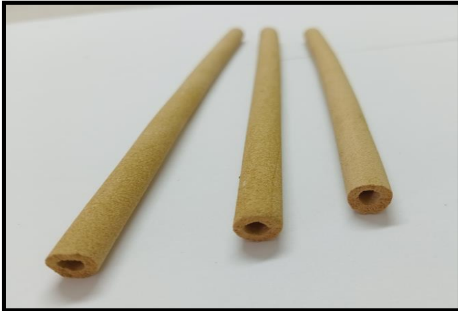
الشكل (13.II): صورة لبعض العينات من الحوامل بعد المعالجة الحرارية بين 1140^{\circ}\text{C} -
