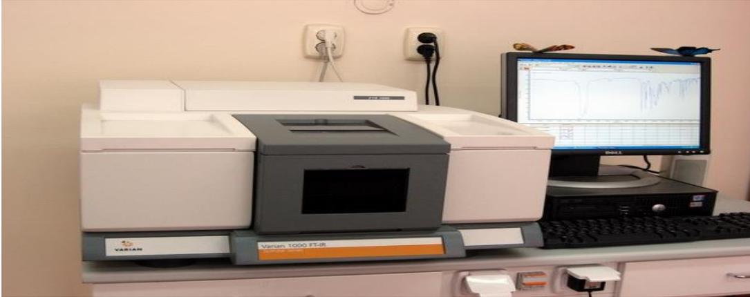
**Figure II .5** : Image Spectromètre Infrarouge à Transformée de Fourier
