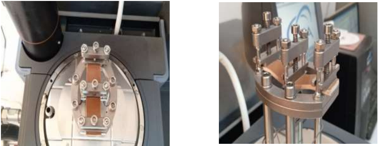
Figure III.18 : Installation de l'échantillon dans la machine
