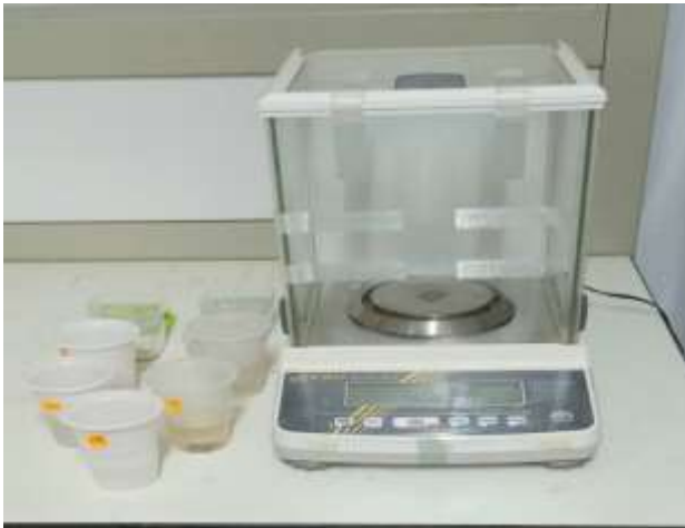
Figure III.14 : Pesée des échantillons (m) après l'immersion.
