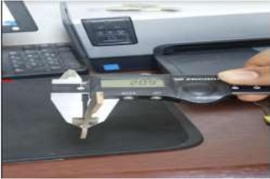
Figure III.10 : Mesure des dimensions de l'éprouvette
