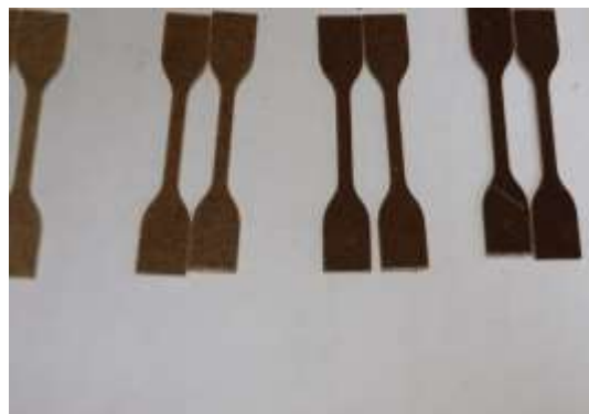
Figure III.9 : Découpage des éprouvettes
