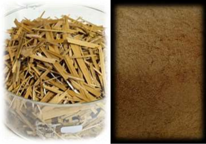
Figure III.3 : fibres traitées par silane
