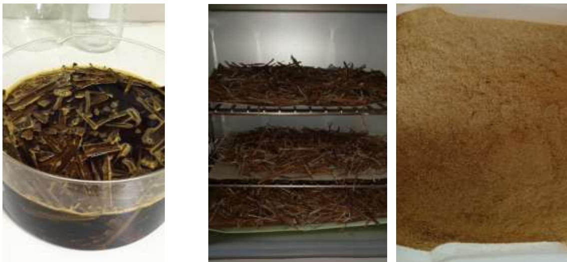
Figure III.2 : fibres traitées par NaOH
