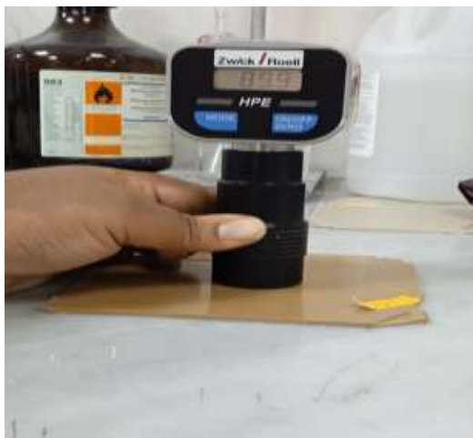
Figure III.13 : Test de la dureté Shore.
