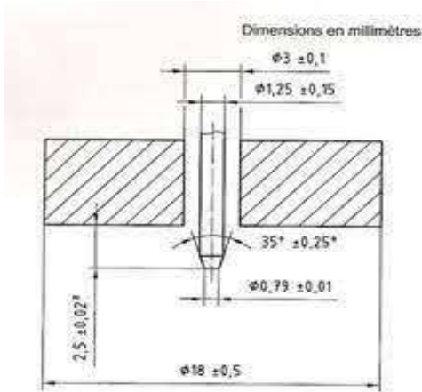
Figure III.12 : Principe de d'uromètre Shore
