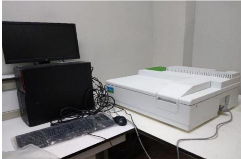
الشكل 9.II : Perkin Elmer Lambda 35 UV/Vis
