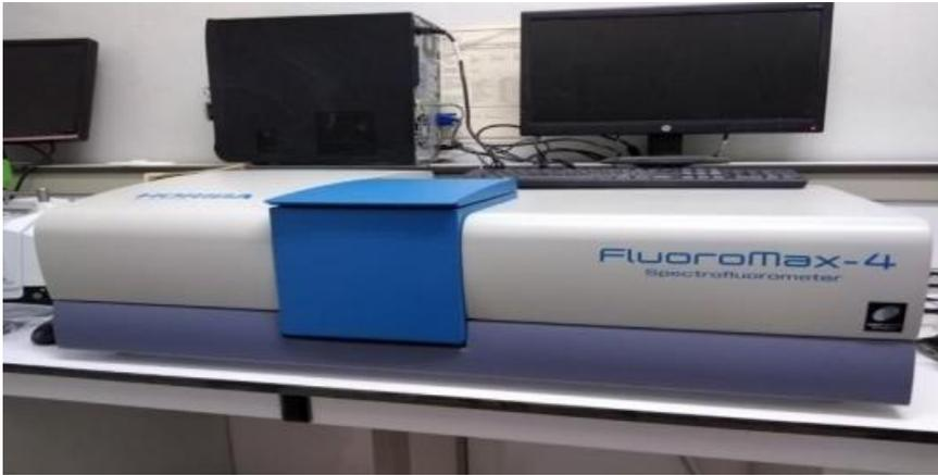
الشكل 12.II : جهاز قياس الطيف الضوئي spectrofluorometer
