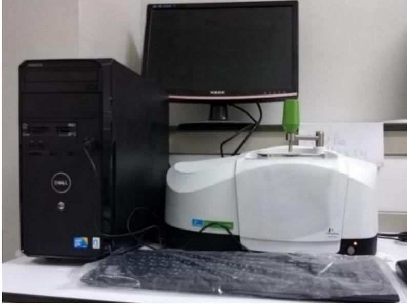
الشكل 11.11 : جهاز مطياف الأشعة تحت الحمراء Perkin Elmer FT-IR spectrometre
