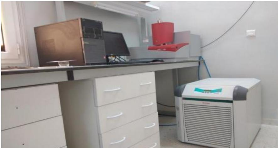
الشكل 8.II: جهاز المسعر التفاضلي الماسح DSC
