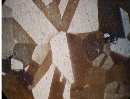
**Figure 3.1** : Microstructure de l'alliage Cu-37% at. Mn à l'état initial
