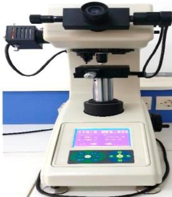
**Figure 2.5** : Microduromètre type Wolpert Wilson.
