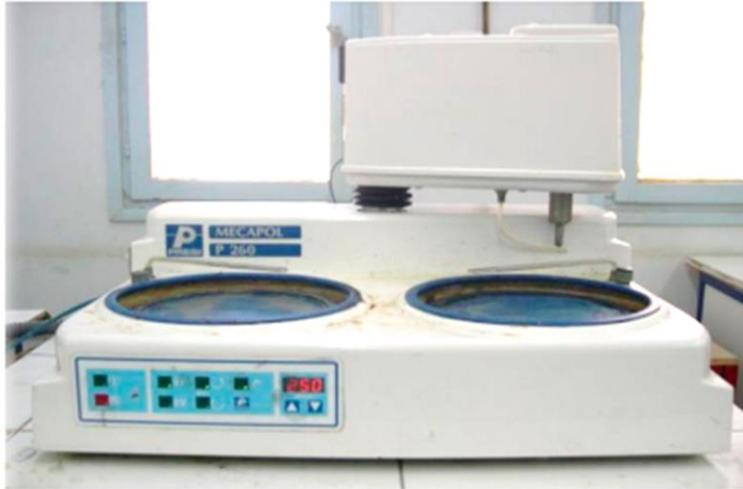
**Figure 2.3** : Polisseuse mécanique de type PRESI MECAPOL P260
