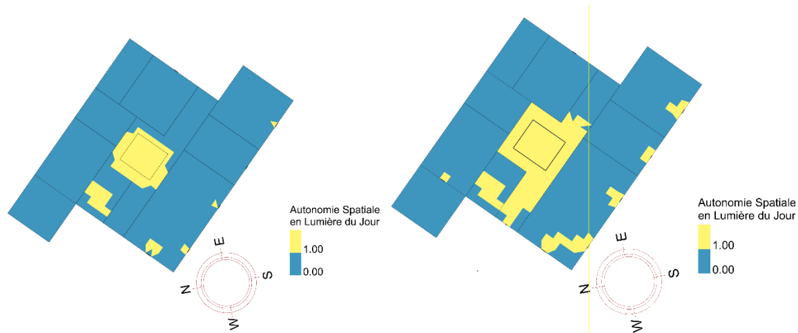
Figure 157 : Résultats de la simulation de l'autonomie en lumière du jour dans la configuration N°, gauche le plan du RDC, droite Plan du 1er étage, les plans sont positionnés vers le nord.
