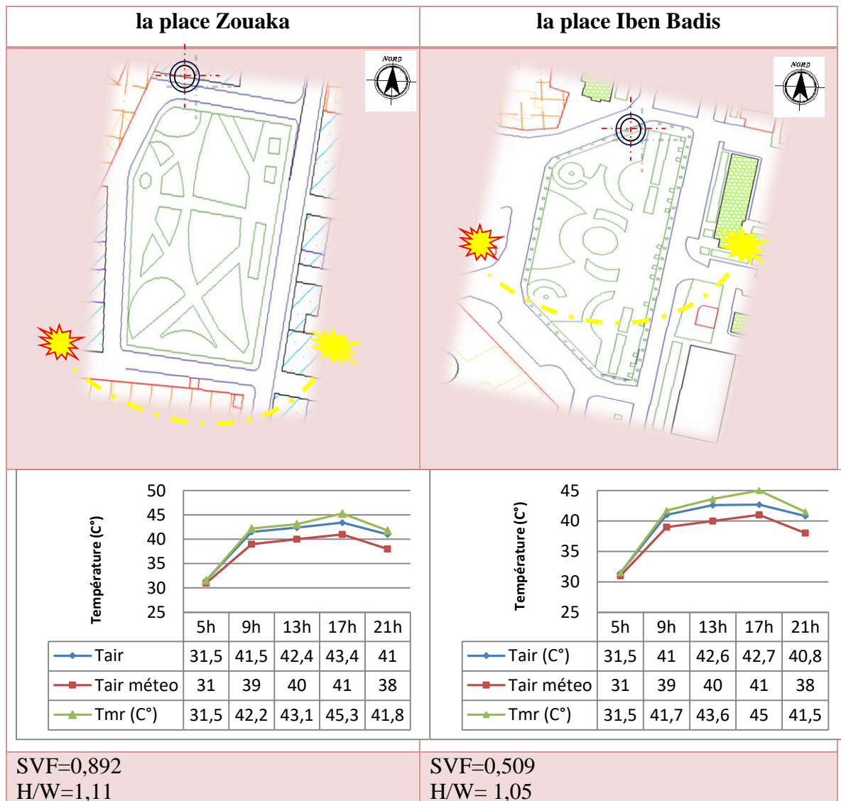
Figure V. 3: Comparaison des facteurs morphologiques et l'environnement thermique dans deux places, établit par auteur, 2018
