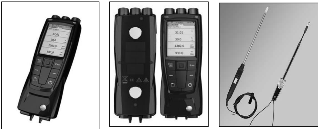
Figure IV. 21: L'instrument de mesure TESTO 480 utilisé dans cette expérimentation. Source : auteur, 2016
