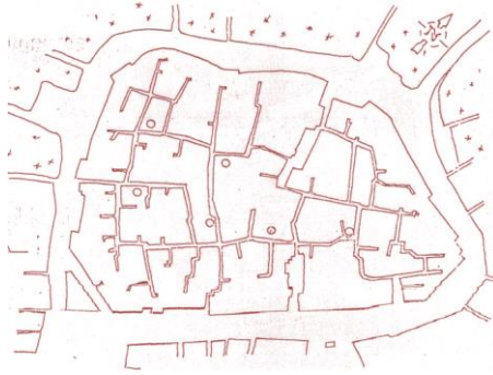
Figure II. 19: Le ksar de Tamacine, orientation des ilots par rapport aux vents dominants, établi par auteur, 2013.
