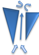
Figure II. 23: Le rétrécissement des voies et l'effet de venturi. Source : auteur, 2013.
