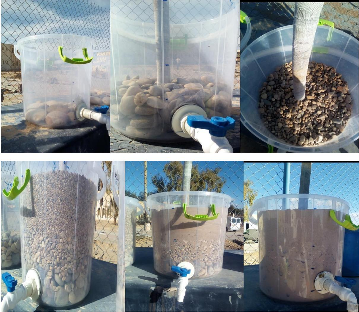
Figure I.2. Préparation du substrats et remplissage des filtres de la première partie
