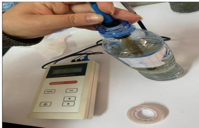
Figure 1.6. Multi paramètres utilisé pour la mesure des paramètres physiques
