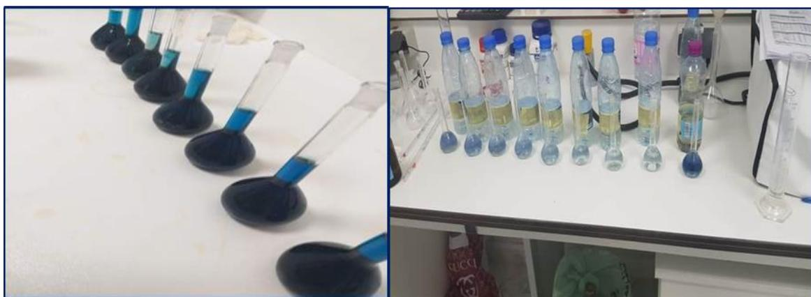
Figure I.12 : La gamme d'étalonnage et le dosage L'ortho-phosphate.
