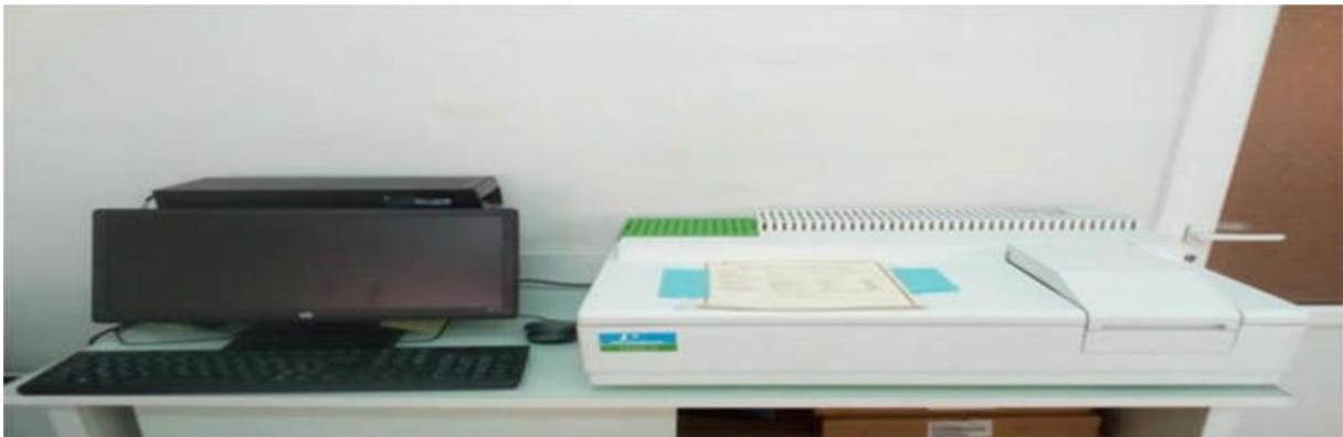
Figure I.14. Photo du Spectromètre UV-visible
