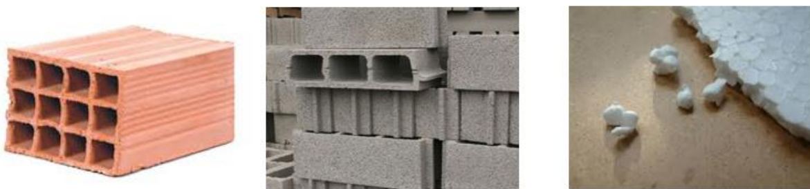
Fig.105 : Les matériaux de construction moderne utilisée, Brique creuse, parpaing, polystyrène. Source : l'auteur, 2020
