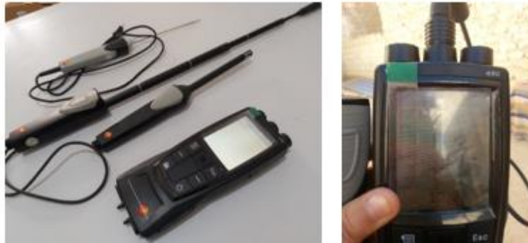
Fig.122. Matériel utilisé dans les campagnes de mesures Testo 480 (Source auteur, 2020)
