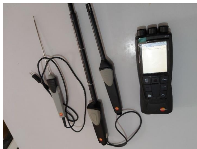
Fig.127 :Équipement utilisé dans les campagnes de mesure(Testo 480). Source (auteur,2020)
