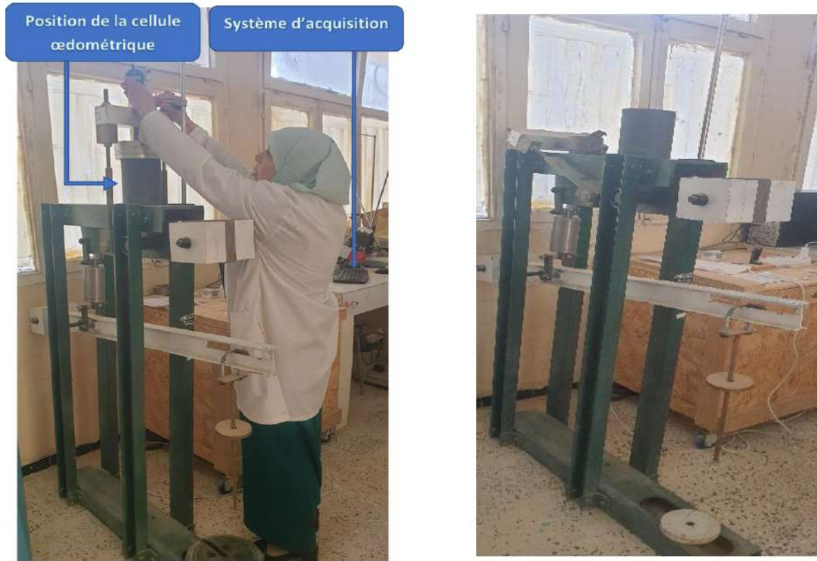
Figure 2. 13 Dispositif œdométrique à haute pression
