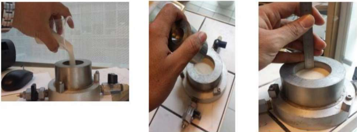
Figure 2. 11 Préparation d'un échantillon de sable, a) versement d'une petite quantité pour former une couche, b) compactage et vibration, c) vérification de la densité.
