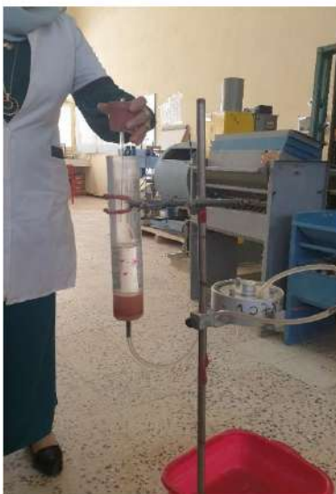
D : Remplissage du tube de Mariotte avec de l'eau
