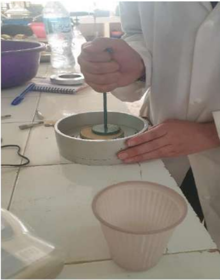
A : compactage de l'échantillon pour assurer l'état de densité
