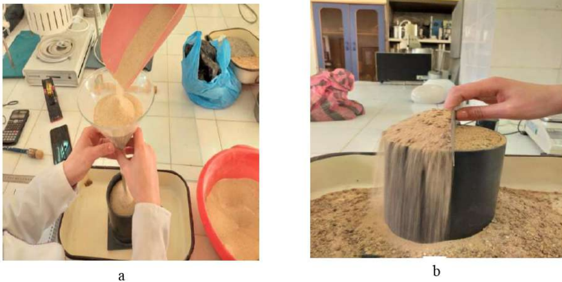
Figure 2.5 Préparation de l'essai pour la détermination de l'indice des vides maximum (a) Versement de sable par l'entonnoir. (b) Élimination de l'Excédent sur le Moule.
