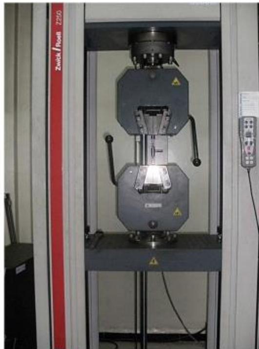
Figure II. 13 : Machine de traction (Zwick Roell Z250) (Laboratoire de Tréfisoud)
