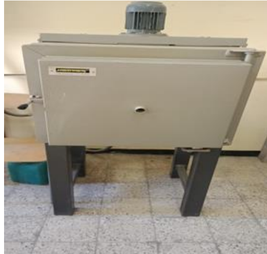
Figure II.6. Four de traitement thermique type Nabertherm D-2804. (Université de Biskra).
