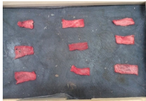
Figure (III- 21) Tranches de pastèque rouge humides et séchées de 4 mm d'épaisseur, le débit 0,016 Kg /s
