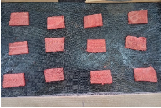
Figure (III- 24) Tranches de pastèque rouge humides et séchées de 4 mm d'épaisseur, le débit 0,023 Kg /s.
