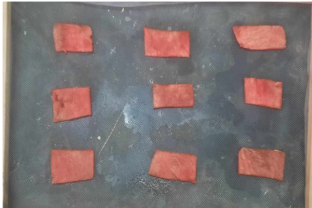
Figure (III- 21) Tranches de pastèque rouge humides et séchées de 4 mm d'épaisseur, le débit 0,016 Kg /s
