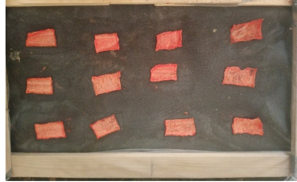
Figure (III- 24) Tranches de pastèque rouge humides et séchées de 4 mm d'épaisseur, le débit 0,023 Kg /s.
