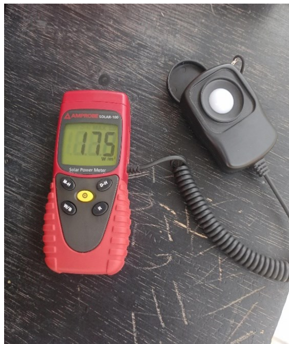
Figure (III- 10) pyranomètre (modèle Amproch SOLAR-100).
