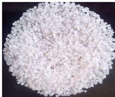
Figure 2.4 : Poudre de NaCl formée de particules de taille qui varie entre 1,5 mm et 2,0 mm.
