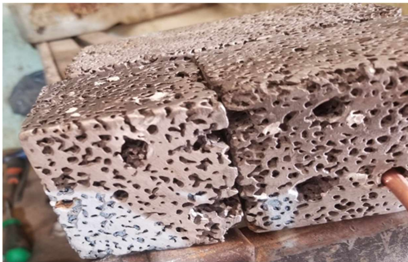
Figure 2.7 : Trois échantillons des mousses d'aluminium préparées par un moule rectangle.
