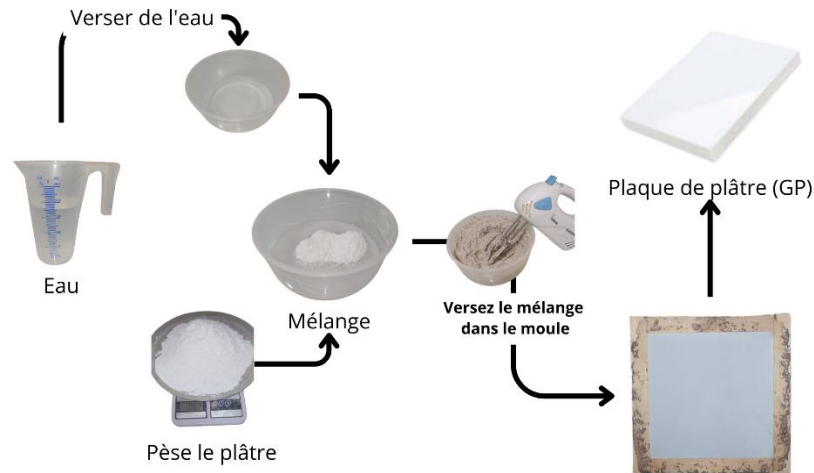
Fig.II.9. Préparation d'une Plaque de plâtre (GP).
