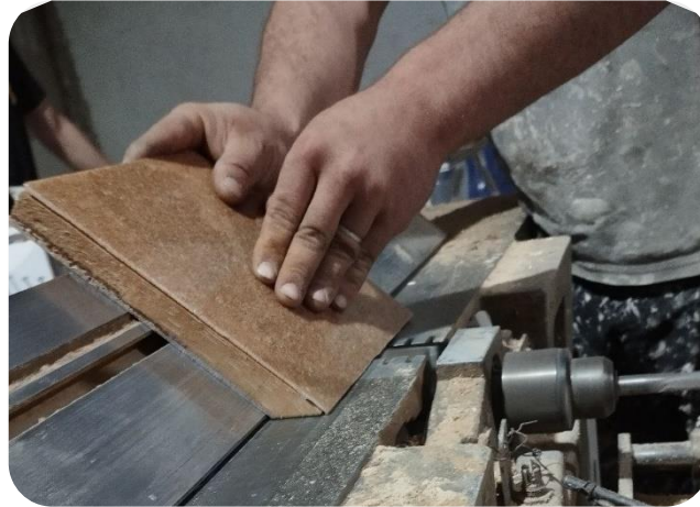
Fig.II.11. Couper des plaques à un angle de 45°.
