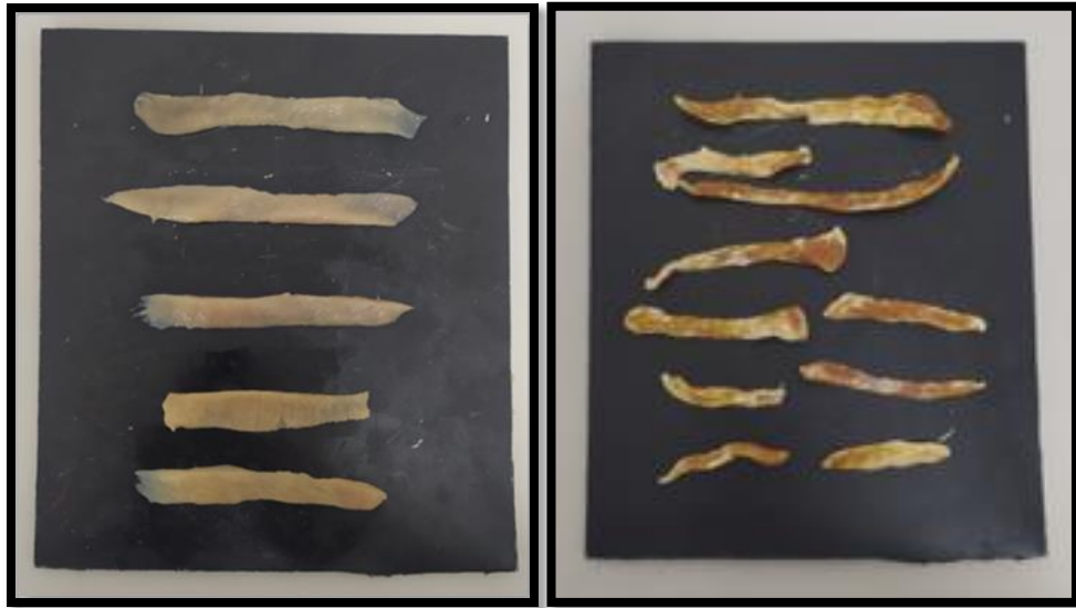
Figure II.24: Des échantillons de poulet humides et séchées par étuve ( T=50^{\circ}\text{C} et Q_m=0,004\text{Kg/s} ).
