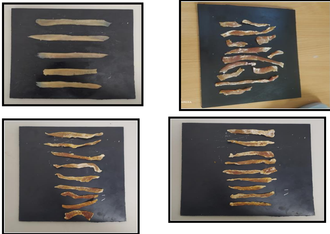
Figure II.18 : Des échantillons avant et après séchage à ( T=40^{\circ}\text{C} ) de 4mm d'épaisseur a même teneur en NaCl et a ( Q_m=1\text{g/s} ; 3\text{g/s} ; 4\text{g/s} ).
