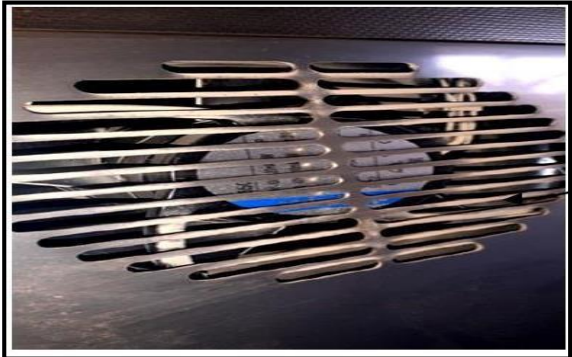
Figure II.11 : Ventilateur d'admission d'air à l'intérieur de l'Etuve de séchage Naberterm ( 30-3000°C ).
