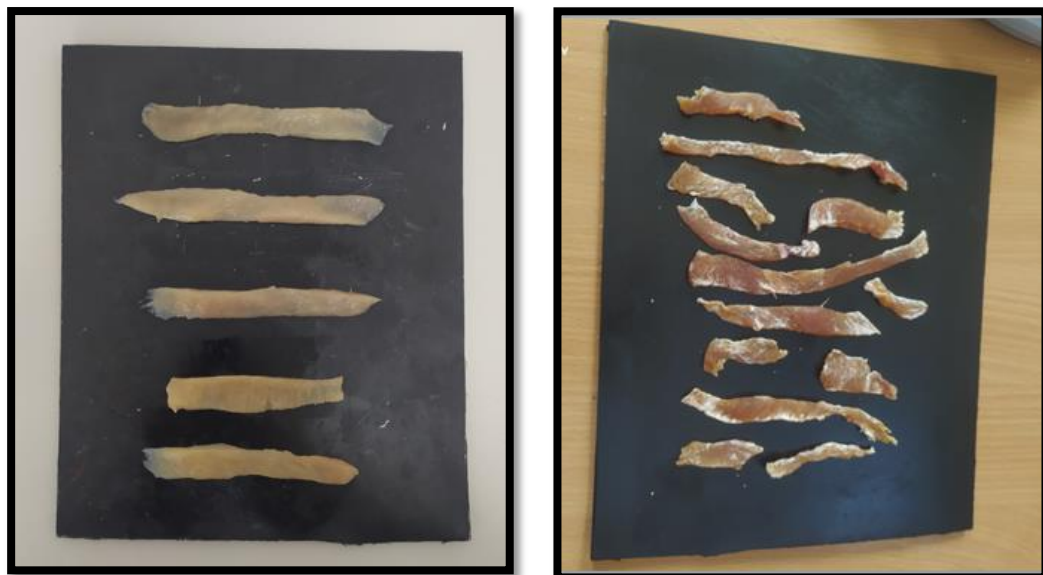
Figure II.19: Des échantillons de poulet humides et séchées par étuve ( T=40^{\circ}\text{C} et Q_m= 0,001\text{ Kg/s} ).
