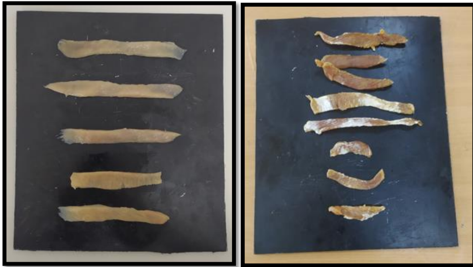
Figure II.22: Des échantillons de poulet humides et séchées par étuve ( T=50^{\circ}\text{C} et Q_m=0,001\text{Kg/s} ).
