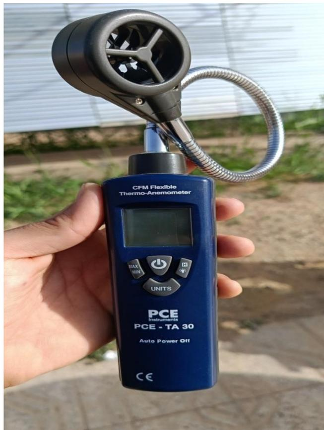
**Figure (III- 8)** Appareil de mesure de la vitesse du vent
