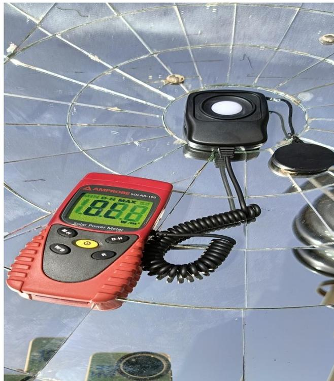
**Figure (III- 7)** Appareil de mesure de rayonnement solaire (le pyranomètre)
