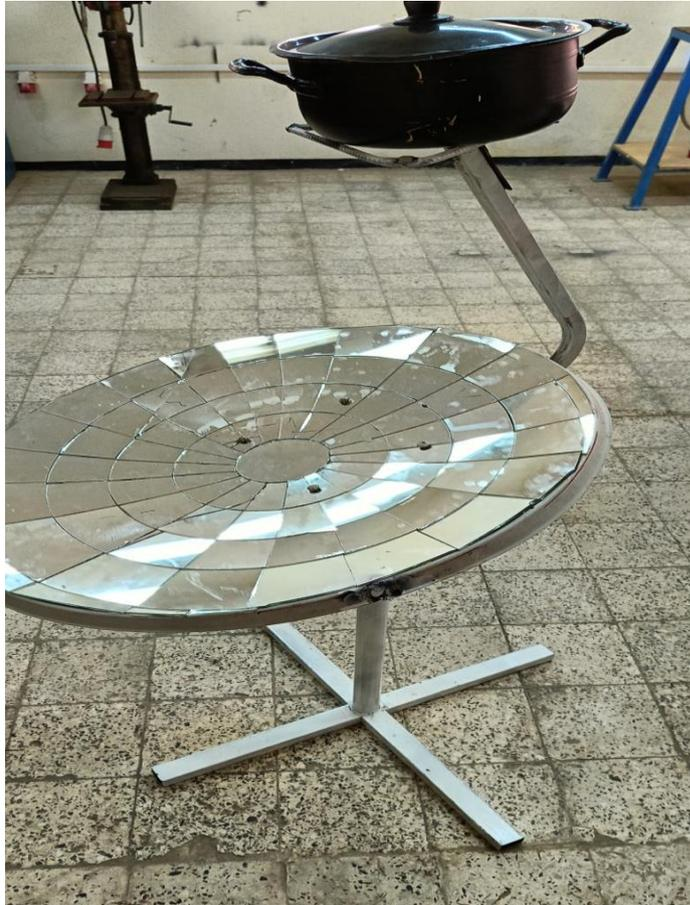
**Figure (III- 10)** Vue générale du cuiseur réaliser
