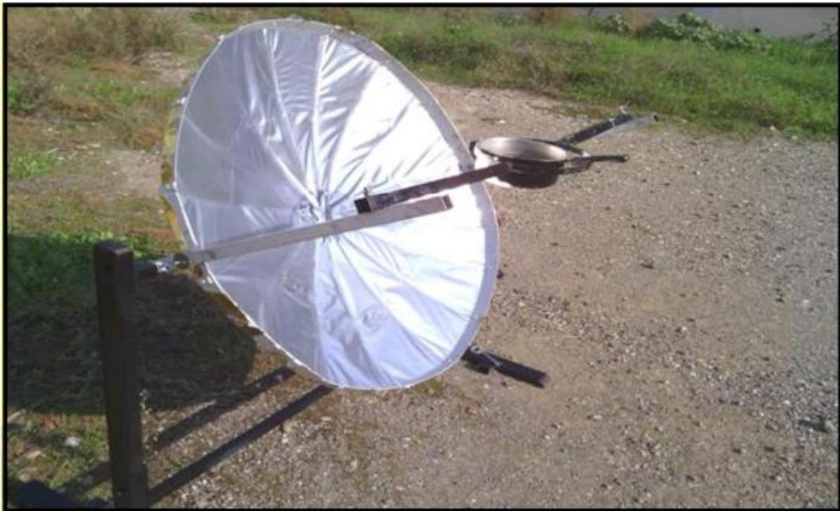
**Figure (II- 13)** chauffage d'un litre d'eau avec le concentrateur réalisé [5].
