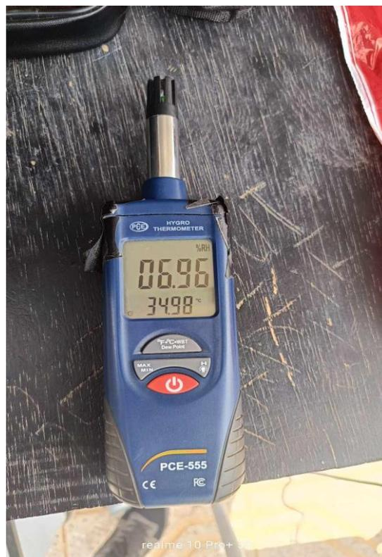
Figure (III- 5) Appareil de mesure de la température et de l'humidité de l'air
