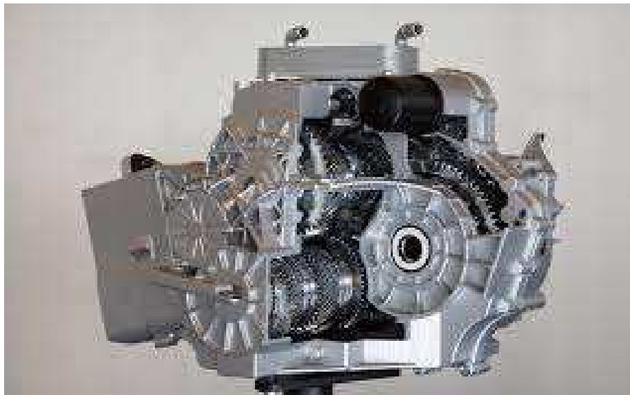
Figure I.10 : Boîte DSG 10 rapports pour moteurs transversaux (DQ511)
