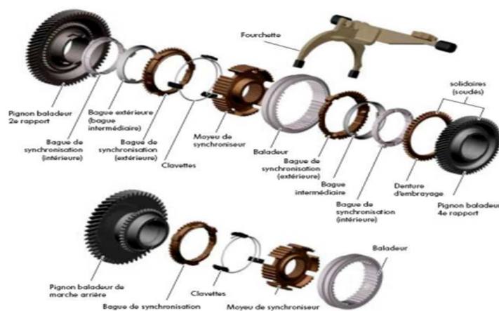
Figure II.4 : Conception du synchroniseur.
