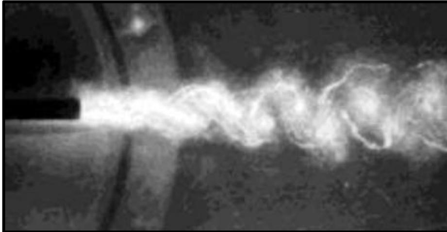
Figure II-7 : tourbillons cavitants en aval d'un obstacle[21].
