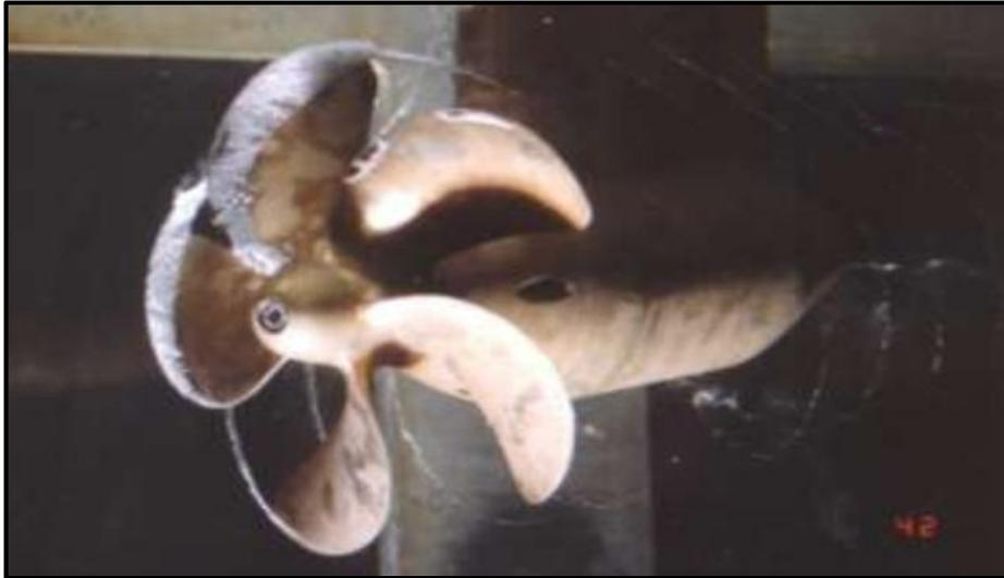
Figure II-5 : cavitation à lames sur une pale d'hélice[21].
