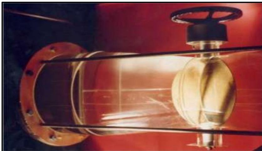
FigureII-8 : cavitation de mélange en aval d'une vanne papillon [22].
