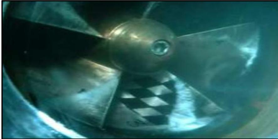
Figure II-3 : Cavitation à poches sur une roue de pompe[21].
