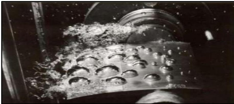
Figure II -2 : cavitation à bulles sur un profil d'aile[21].
