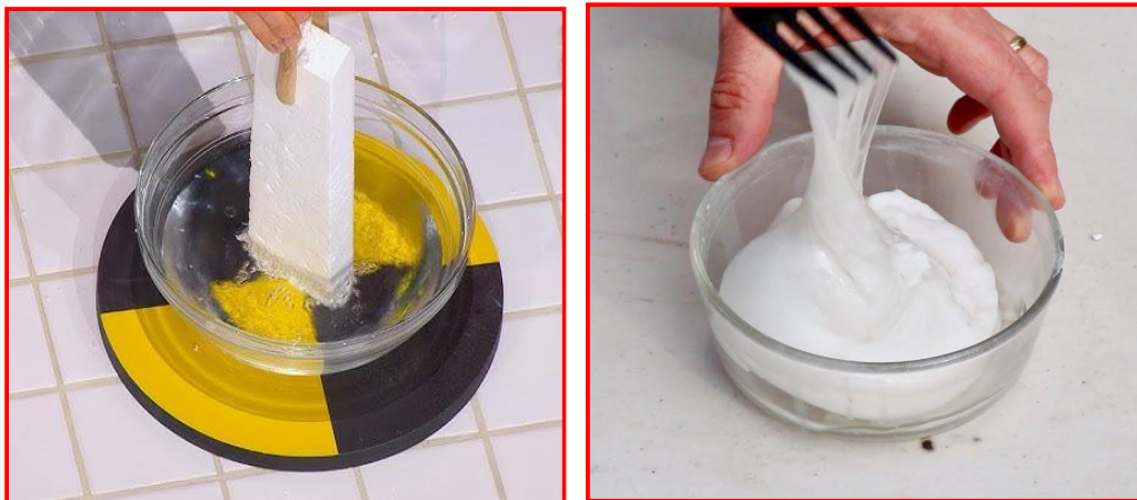
Figure 3. 1: Recyclage du polystyrène par l'essence (Matrice EPS).
