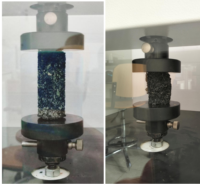
Figure 3. 4: Epreuve en compression non déformé et déformé.
