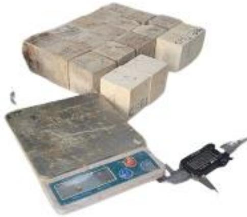
الشكل 7.II. أدوات قياس الكتلة الحجمية الظاهرية.
