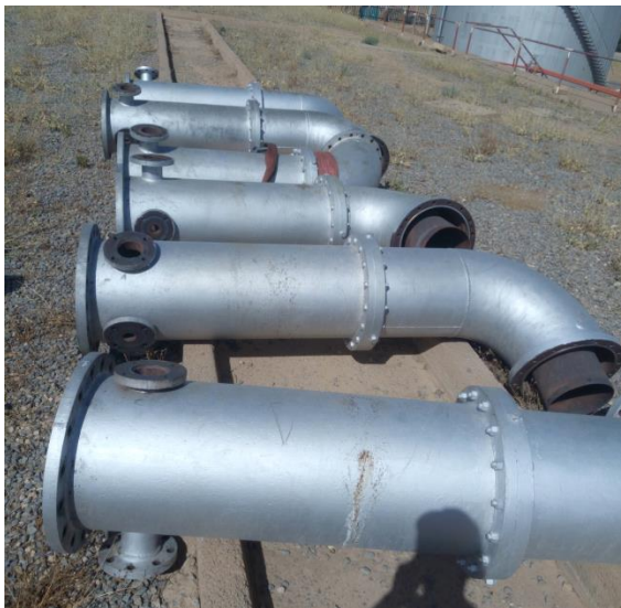
Figure II 1 : chambres de combustion
