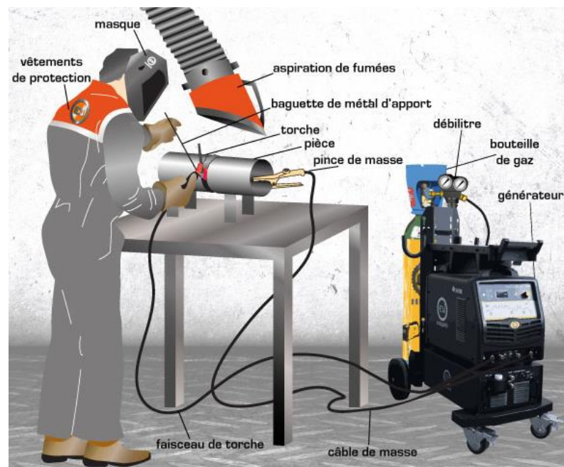
Figure I 20: Equipement et l'installation pour le soudage TIG[11]
