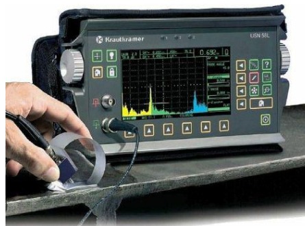
Figure I 40 : Control des pièces industrielles par ultrason [25]
