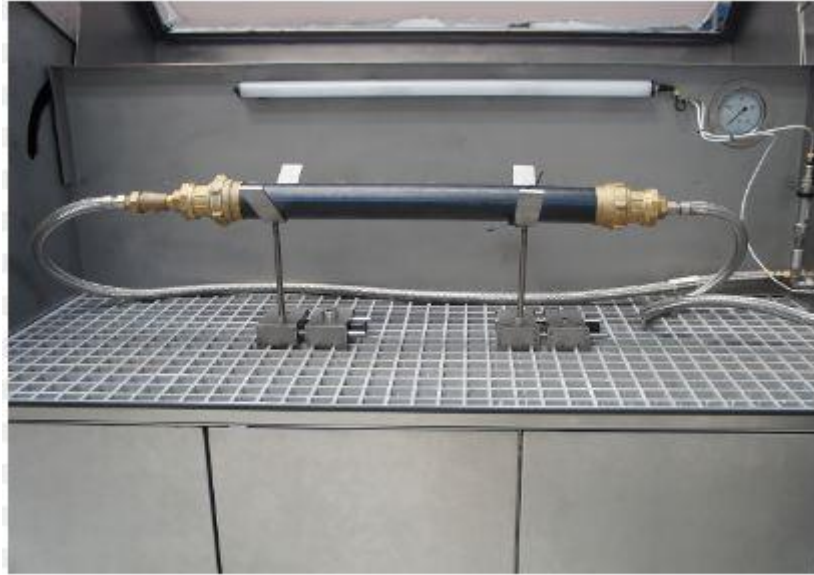
Figure I 38 Essai de pression hydrostatique [26]
