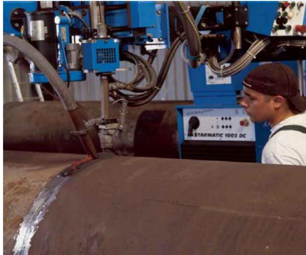
Figure I 18: soudages à l'arc automatique sous flux[11]
