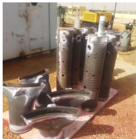
Figure III 4: Etape : application du révélateur
