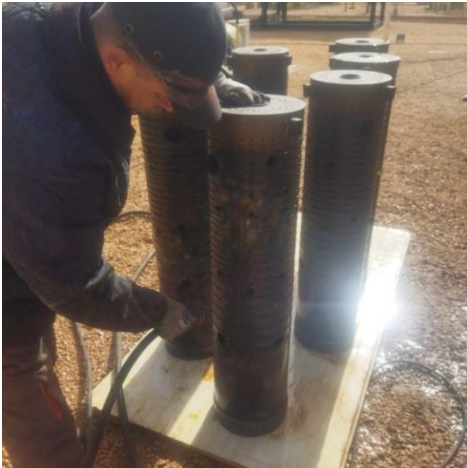
Figure III 3: Etape élimination du pénétrant
