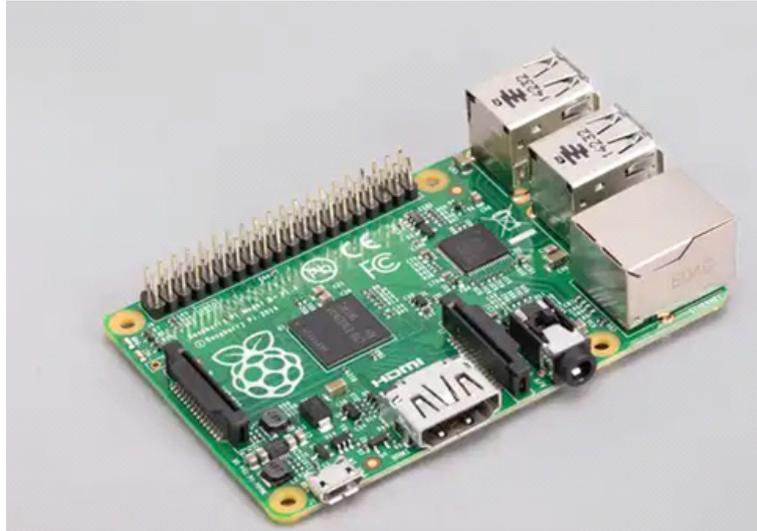
**Figure 2.10 :** Raspberry Pi 1 Modèle B+ [15]
