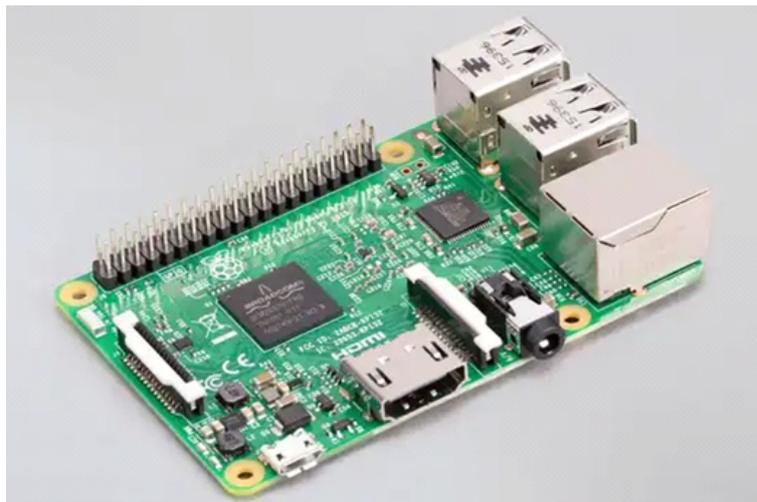
Figure 2.9 : Raspberry Pi 3 Modèle B [14]
