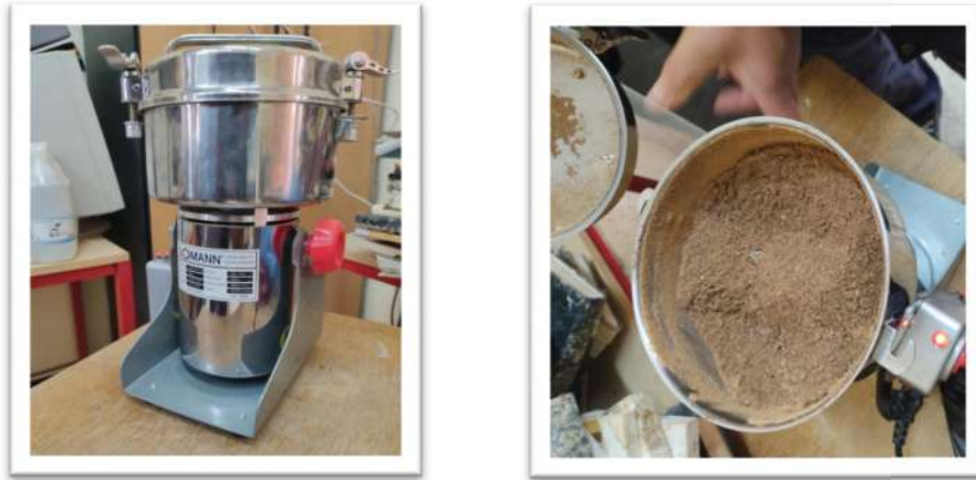
Figure II.5 : Le broyeur et les noyaux broyés.
