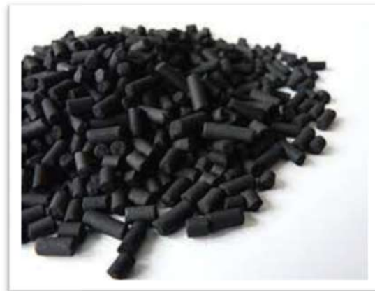
Figure I.11 : Charbon actif extrudé [67].
