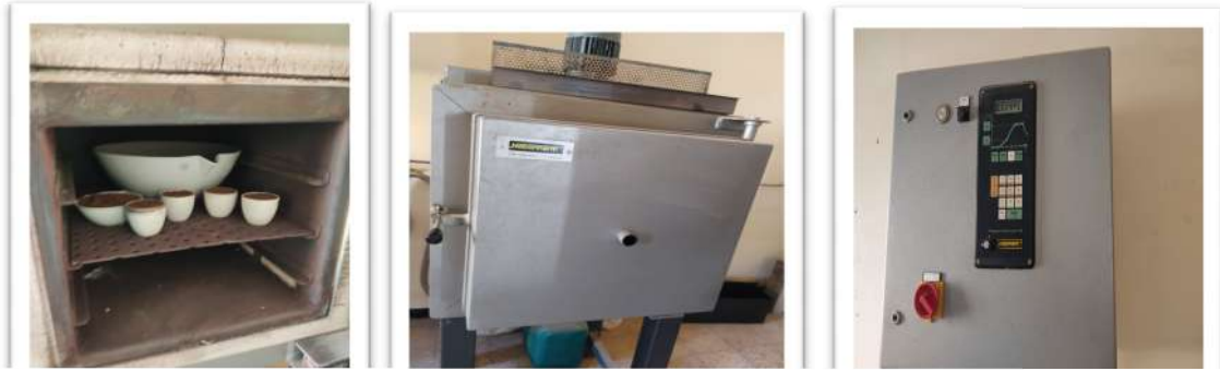
Figure II.8 : Calcination le produit en poudre et en grain dans le four.
