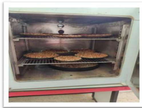
Figure II.4 : Noyaux séchés à l'étuve.
