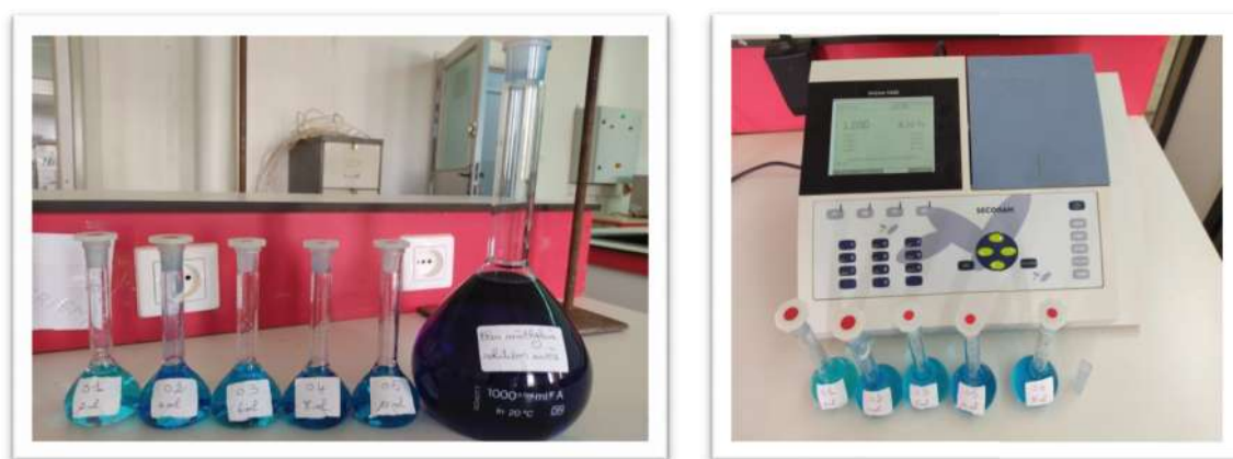
Figure II.13 : Préparation de la solution mère et des solutions filles du bleu de méthylène
