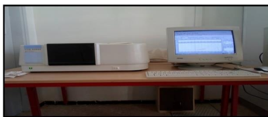
Figure II.3: Spectromètre Infrarouge à transformée de Fourier Shimadzu 8400s. [2]
