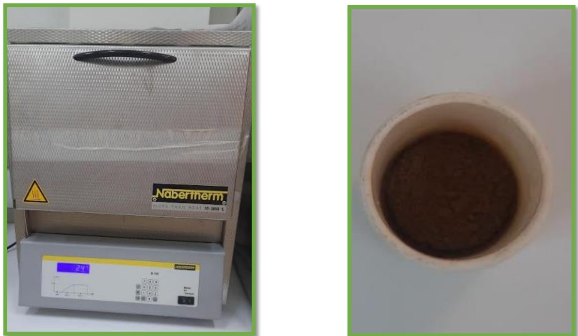
Figure.III.7 : calcination sur le four programmable avec une vitesse 2°C/min à déférents températures (600-700-800) °C.
