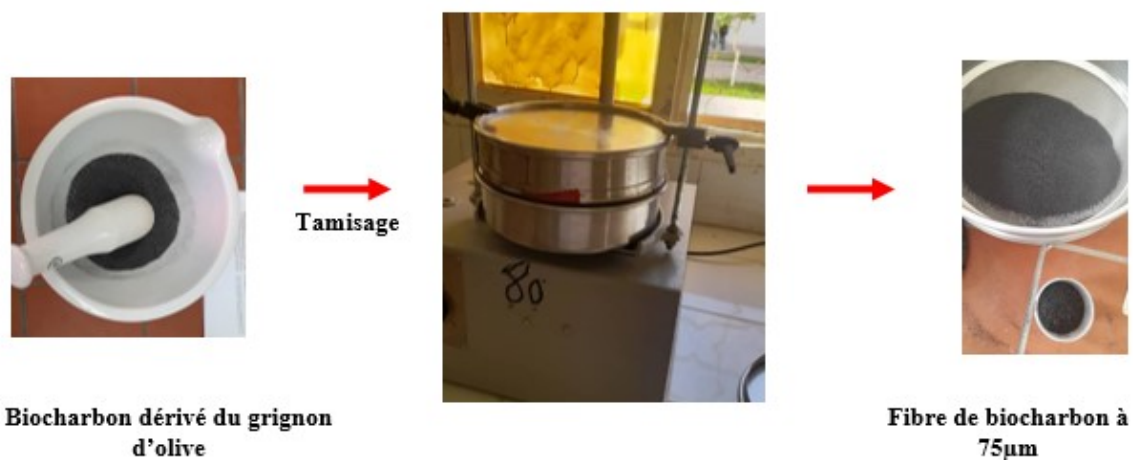
Figure II.3 : Préparation de biocharbon après pyrolyse
