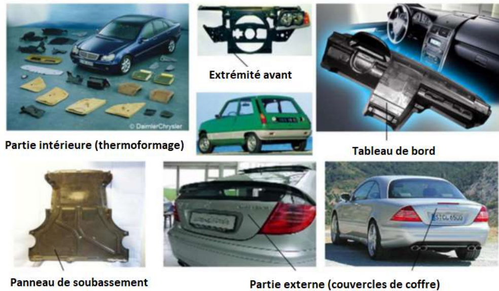
Figure I.5: Pièces automobiles fabriquées à partir de composites polymères [26]
