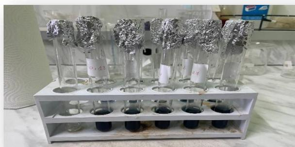
**Figure III. 6:** Gamme d'étalonnage des polyphénols totaux.
