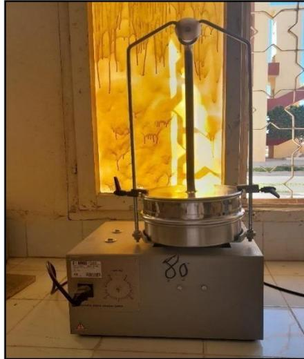
Figure II.15 : Procédé de tamisage à l'aide d'un tamis de diamètre 63  $\mu\text{m}$ .
