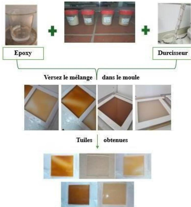
Figure II.16 : Préparation et moulage des bio-composites.
