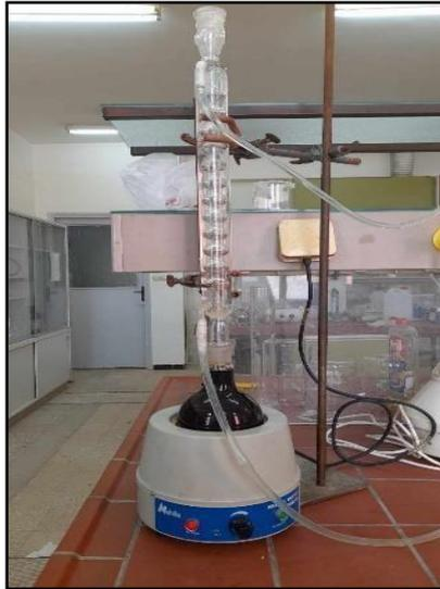
Figure II.11 : Le montage de chauffage à reflux
