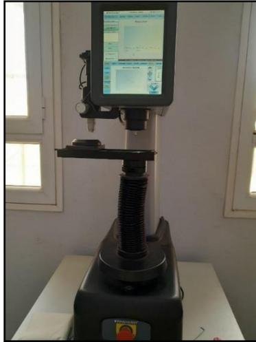
Figure II.20 : Micro-duremètre Vickers INNOVATEST VERZUS 750.
