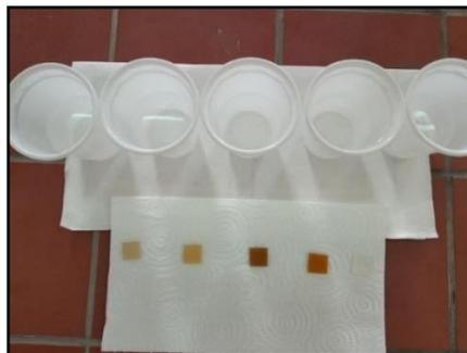
Figure II.21 : Test d'absorption d'eau pour les composites Epoxy/Fibres.
