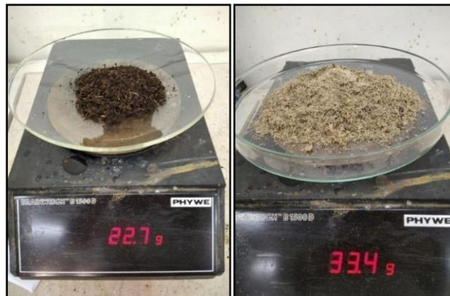
Figure II.8 : Les échantillons après le traitement alcalin
