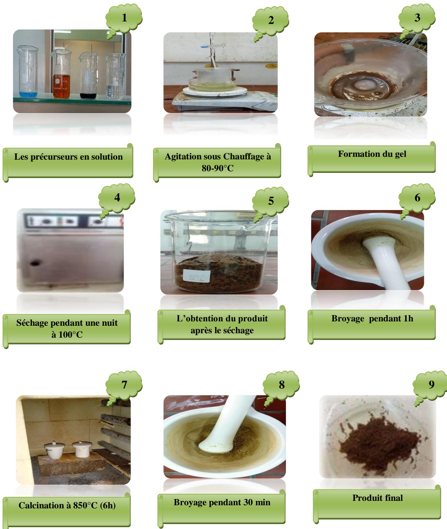
Figure III.2: Les étapes de la synthèse  $\text{BiFe}_{1-x}\text{Cr}_{x/2}\text{Cu}_{x/2}\text{O}_3$  par la méthode citrate
