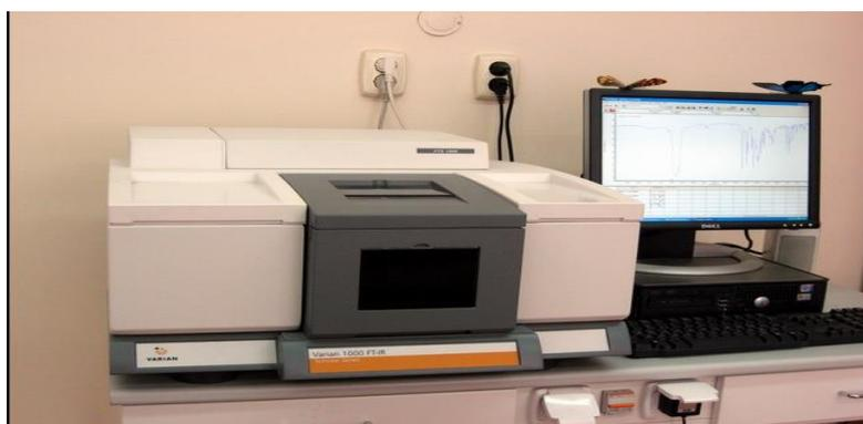
FigureII .4 : L'appareille le spectromètre FTIR
