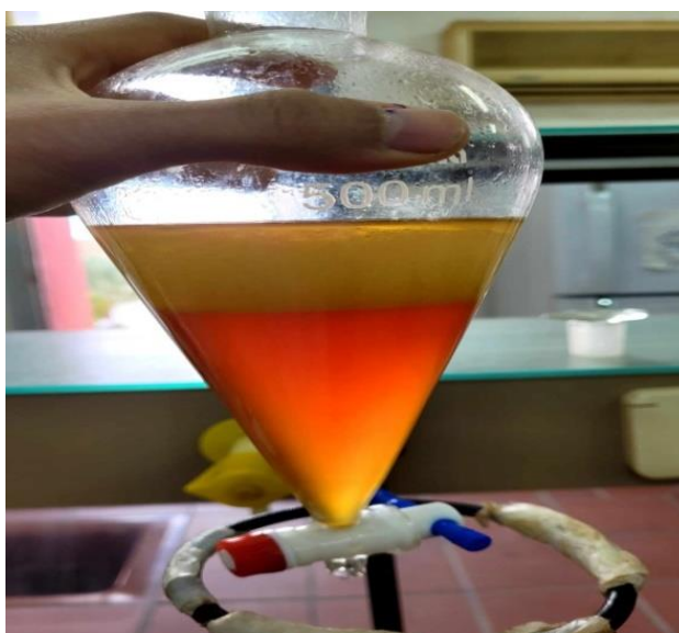
Figure III-5 : l'extraction liquide-liquide par le n-butanol
