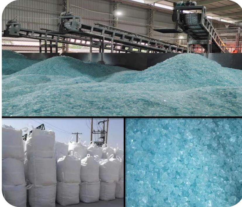
**Figure III.4 :** Silicate de sodium solide sous forme morceaux.
