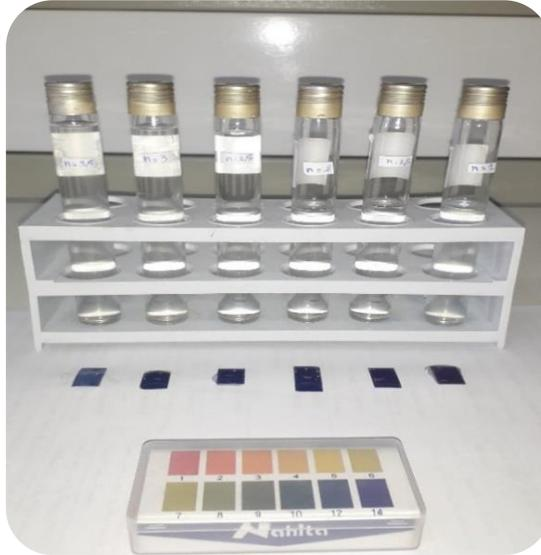
**Figure III.22 :** La série des solutions de silicate de sodium préparées avec différents rapports molaires.
