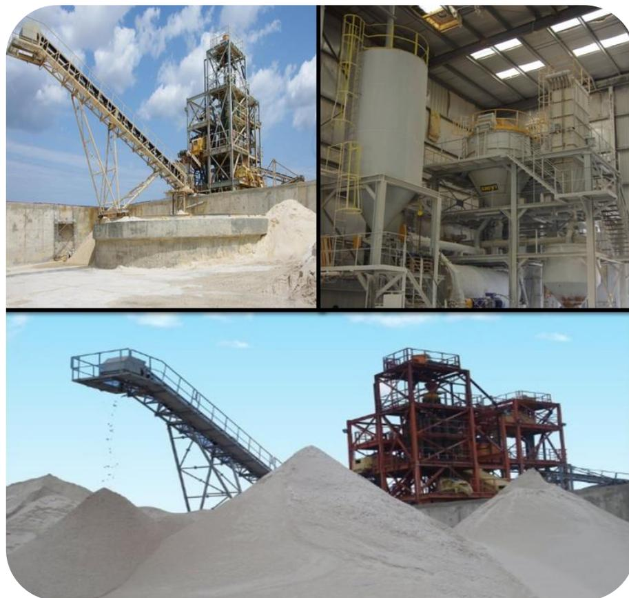
**Figure III.1** : Le sable de quartz utilisé pour la production de silicate de sodium, et sa station de traitement, dans les usines.
