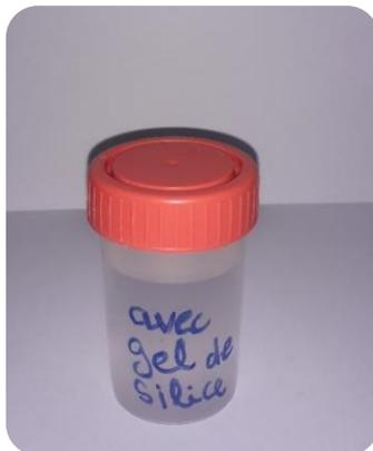
**Figure III.20** : Silicate de sodium liquide obtenu en utilisant le gel de silice.
