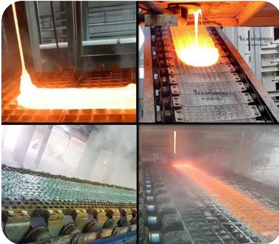
**Figure III.3 :** Refroidissement rapide de silicate de sodium fondu.
