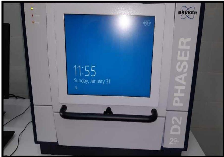
**Figure II.5** : Diffractomètre automatique de poudre, Bruker D2 Phaser, utilisé.
