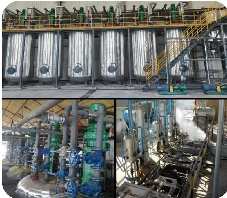
**Figure III.7 :** Réacteur utilisé pour la production de silicate de sodium liquide.
