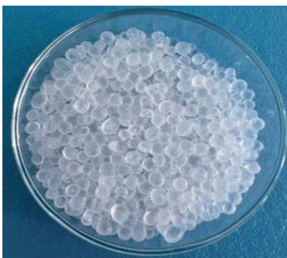
**Figure I.6** : Gel de silice granulé. [55]
