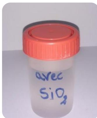
**Figure III.16** : Silicate de sodium liquide obtenu en utilisant le dioxyde de silicium.
