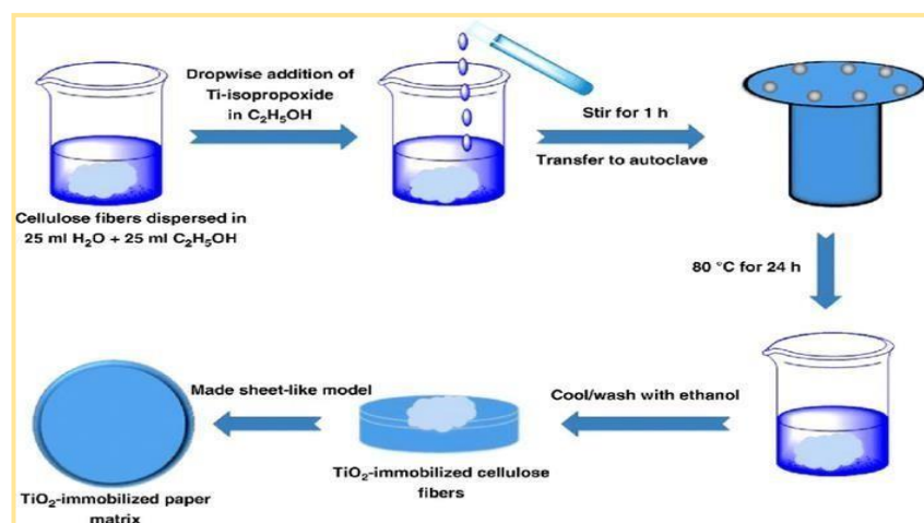
Figure I.8 : Schéma de la méthode hydrothermal.
