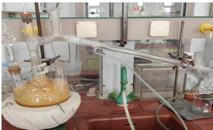
**Figure II.7:** Le montage de hydrodistillation.
