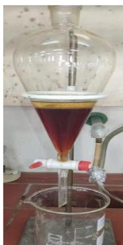
**Figure II.12:** Extraction liquide –liquide par acétate d'éthyle.
