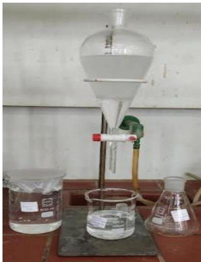
**Figure II.8:** Extractions liquide – liquide par ampoule à décanter.
