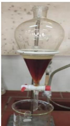
**Figure II.11:** Extraction liquide –liquide par n-hexane
