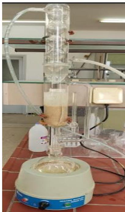
**Figure II.9:** Extractions solide – liquide par méthode de soxhlet.
