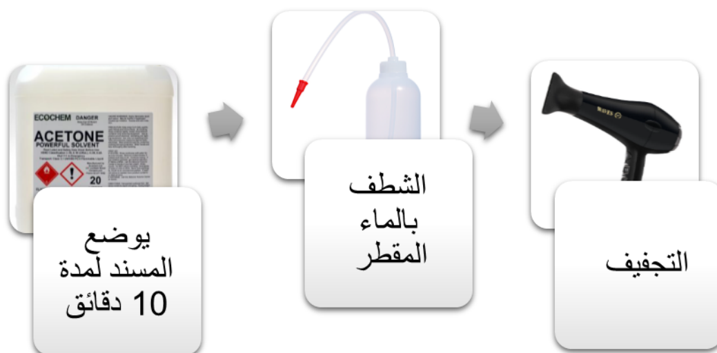
الشكل III-1: الخطوات المستخدمة لتنظيف المسند.
