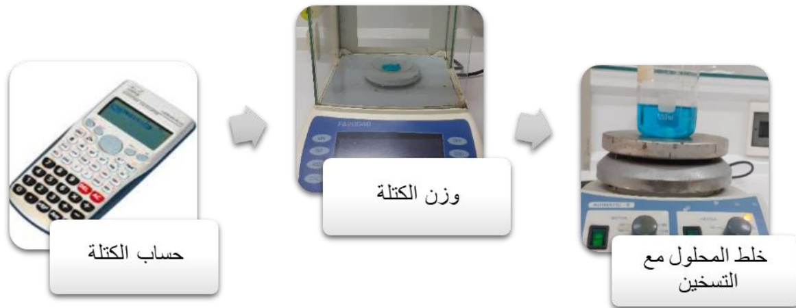
الشكل III-2: عملية تحضير المحلول.
