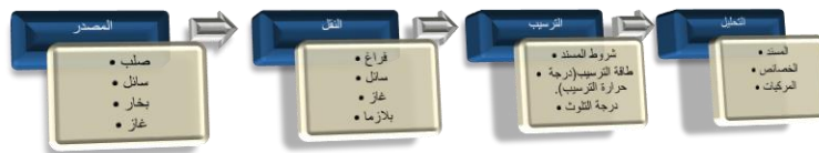
شكل II-1 رسم تخطيطي يوضح خطوات تصنيع الشرائح الرقيقة [14].
