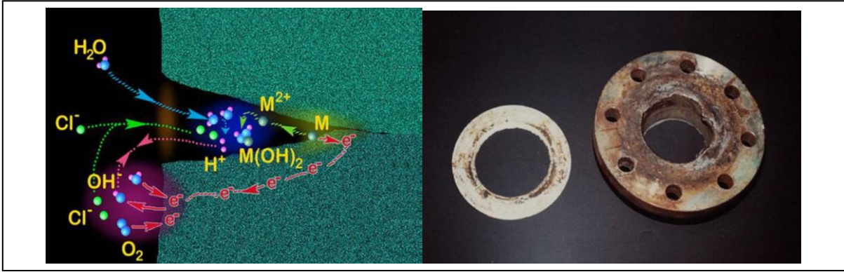
الشكل 6.1. التآكل الانتقائي
