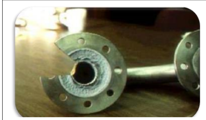
الشكل 7.1. التآكل الشقي
