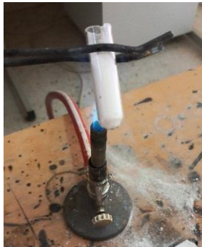
الشكل (II - 4): صور فوتوغرافية لعملية صهر خليط الزجاج.
