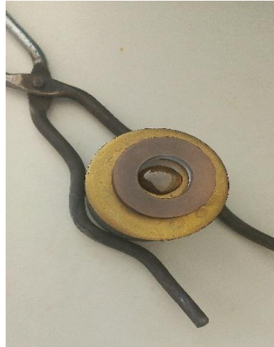
الشكل (II - 7): صورة فوتوغرافية للعيننة الزجاجية بعد استخراجها من الفرن الكهربائي
