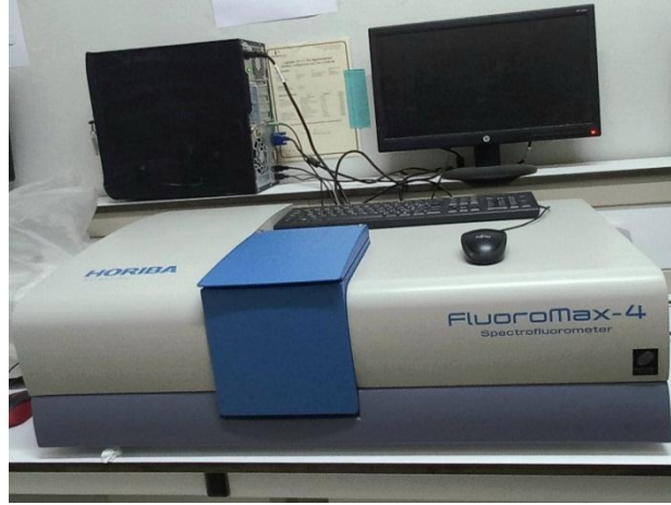
الشكل (II-16): صورة فوتوغرافية لجهاز مقياس الطيف الضوئي
