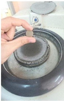
الشكل (II - 8): صور فوتوغرافية لآلة الصقل Pressi-Minitec 233 مع الأوراق الكاشطة المستخدمة.
