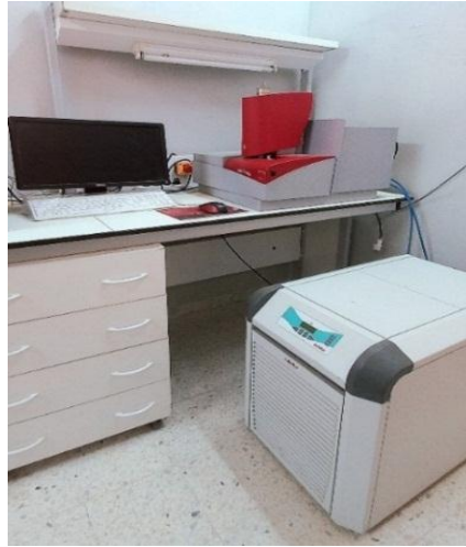
الشكل (II-12): صورة فوتوغرافية لجهاز المسعر التفاضلي الماسح (DSC).
