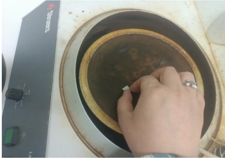
الشكل II-2- الصقل الميكانيكي لعينة الألمنيوم
