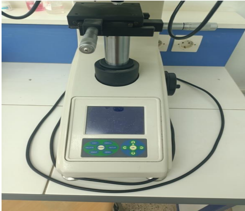
الشكل 8-11- جهاز قياس الصلادة فيكرز نوع wilson wolpert
