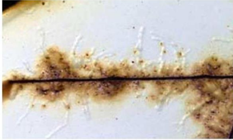
الشكل (9.1): التآكل الخيطي [35].
