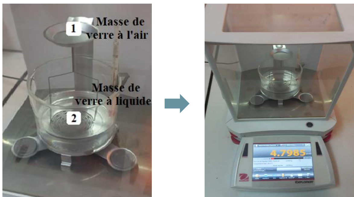
Figure II-11: Balance de mesure la densité (de type OHAUS)
