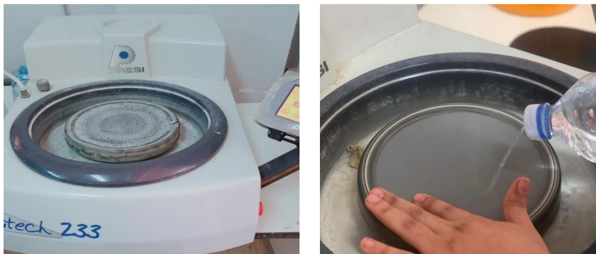
Figure II-7: Procédé de polissage des échantillons.
