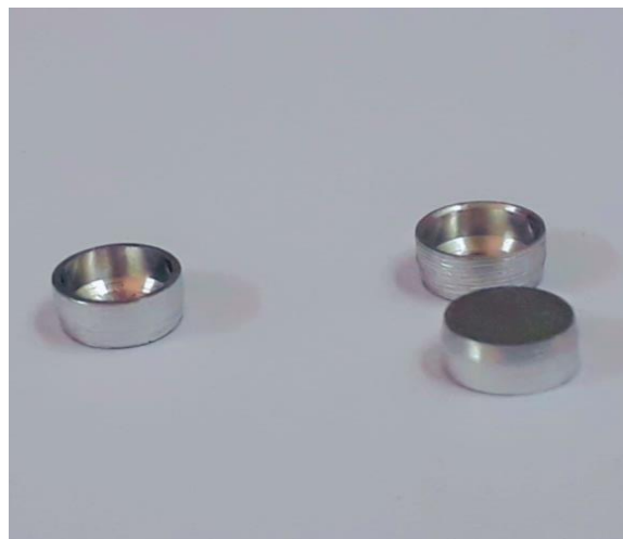
Figure II-8 : Dispositif DSC et capsules d'aluminium
