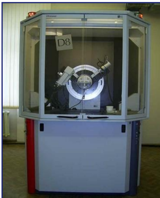
Figure II. 8: Vue générale sur le diffractomètre de rayons X
