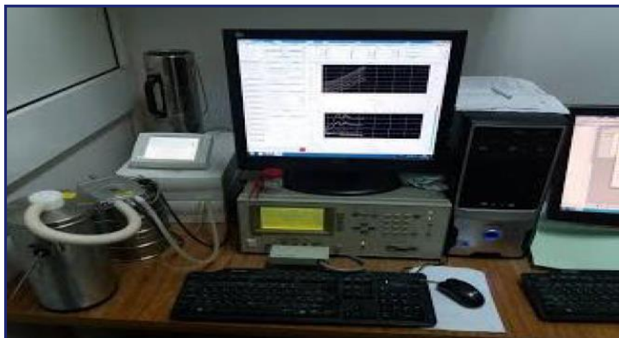
Figure II. 11: Pont d'impédance et cellule de mesures diélectriques de type HP/Agilent 4284A. (LMF-SFAX).
