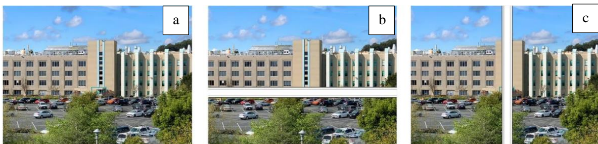
Figure III.6. La clarté d'une vue en fonction de la fragmentation de la fenêtre : a : vue dégagée ; b : meneau horizontal ; c : meneau vertical (Source : Ko et al., 2021).
