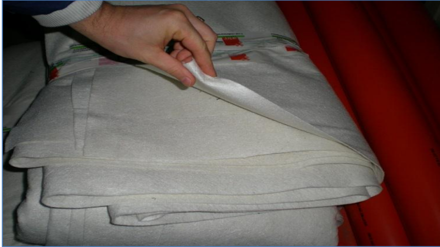
Figure IV.4. Photo d'une géomembrane en polyéthylène.
