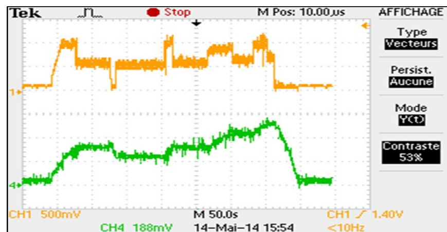
Figure IV-21 : Courant dans la génératrice (image du couple émulé) (Jaune) et la vitesse du moteur (verte) avec le cycle NEDC (parcours extra-urbain).
