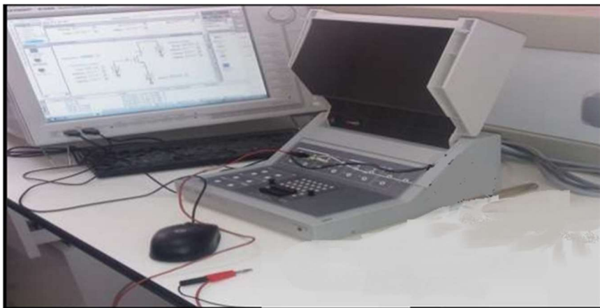
Figure IV.1 : Analyseur de paramètres semi-conducteurs B1500A de Keysight
