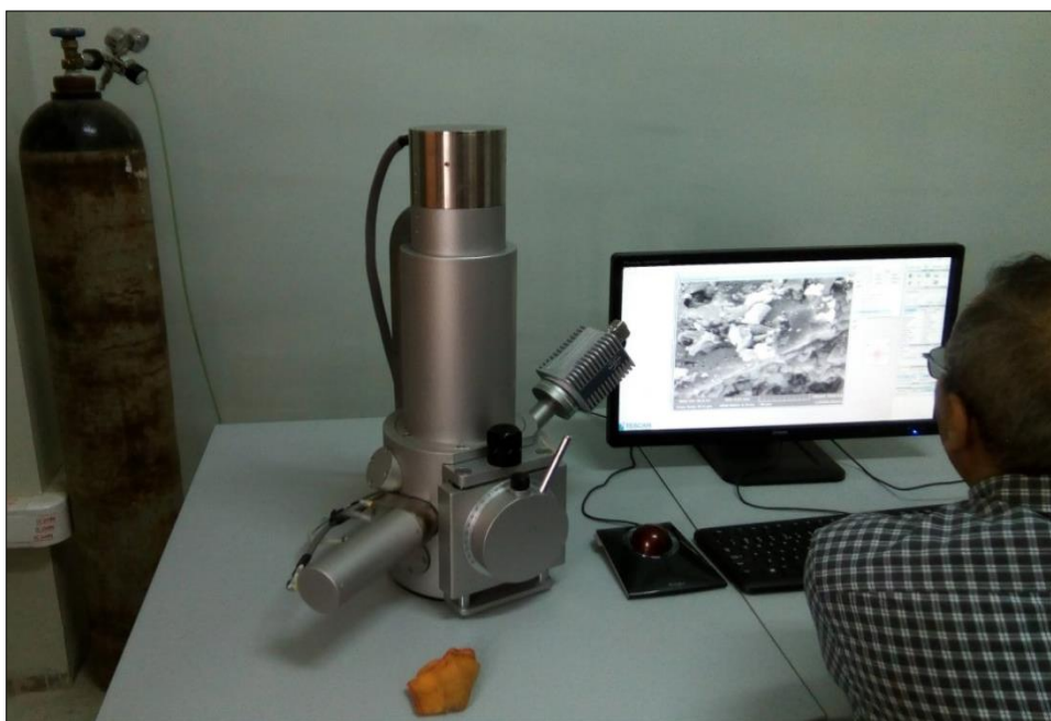
Figure IV.18. Appareil d'analyse électronique à balayage (MEB) du modèle VEGA3 TESCAN.
