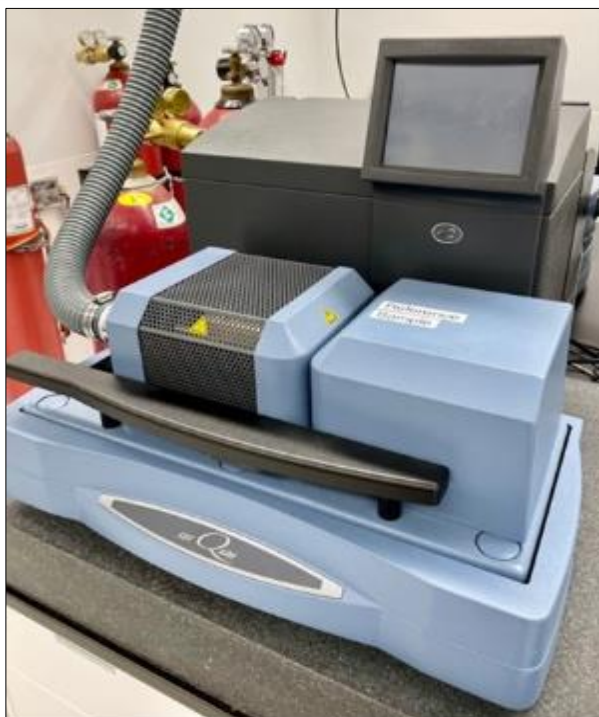
Figure IV.22. Analyseur thermogravimétrique (TA-instruments-Q600) (Université de Sétif)
