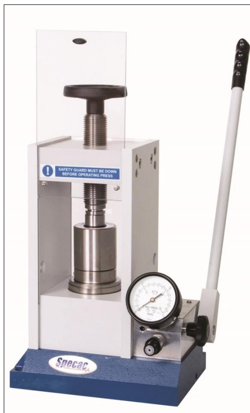
Figure IV.21. Spectrophotomètre de type LAVALLAB (SPECAC) avec presse hydraulique (Université de Biskra)[190].
