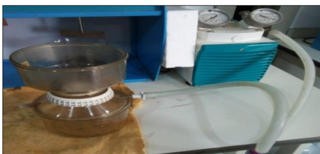
Figure IV.16. Système de filtration des solutions préparés par la pompe à vide FAITHFUL de type GM-0.5.
