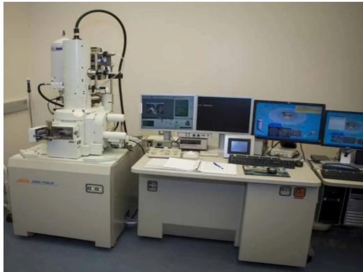
**Figure III.8 :** image réel de dispositif MEB de type JEOL-JSM 7001
