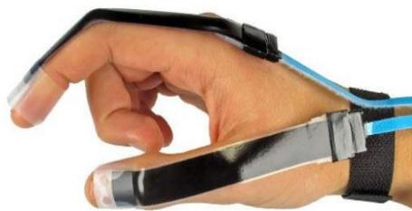
**Figure I.11.** Capteurs DE appliqués directement sur la main permettant de mesurer le mouvement et le comportement. (Image courtesy of StretchSense Ltd [www.stretchsense.com](http://www.stretchsense.com)).
