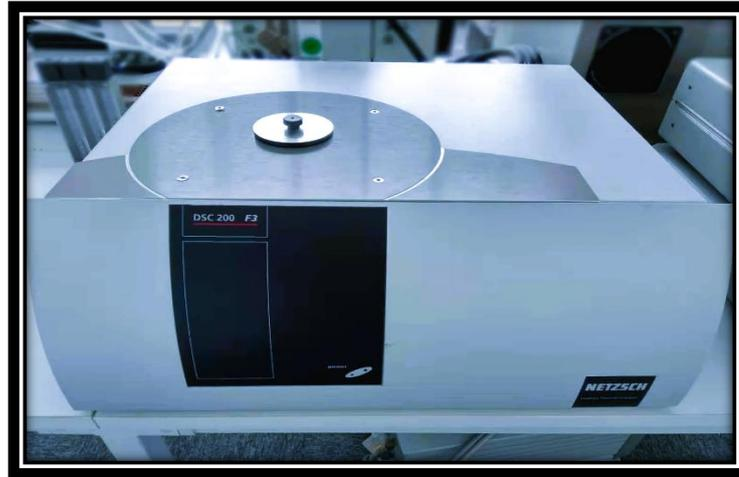
**Figure III.11** : image d'un appareil de calorimétrie différentielle à balayage (DSC) de la marque NETZSCH 200F3
