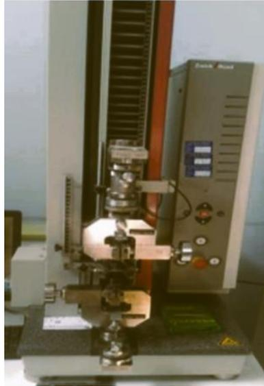
**Figure III.13** : image de la machine de traction model ZwickRoell 2.5 KN
