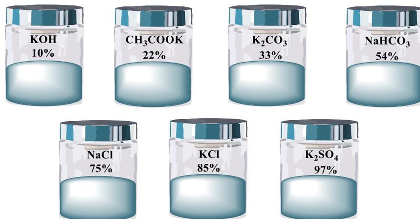
Figure III.5 : présentation des solutions salines saturées
