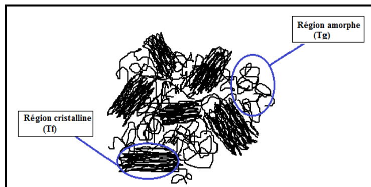
Figure I-8 : Structure d'un polymère semi cristallin
