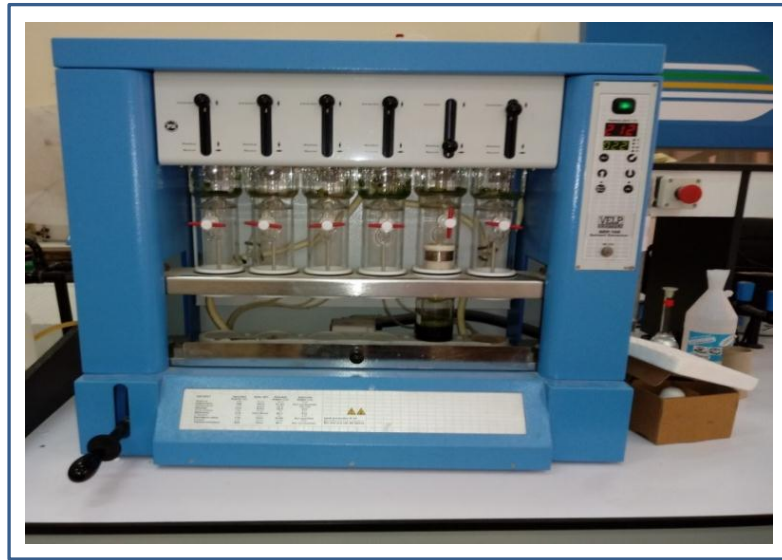
Figure II-3: Appareillage d'extraction par solvant
