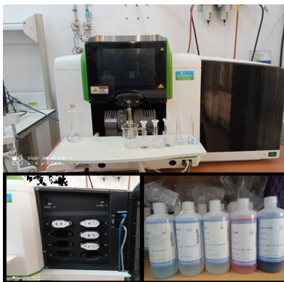
Figure 5. Spectrophotomètre d'absorption atomique (Perkin Elmer PinAAcle 900T, USA (CRASTRA,2024))
