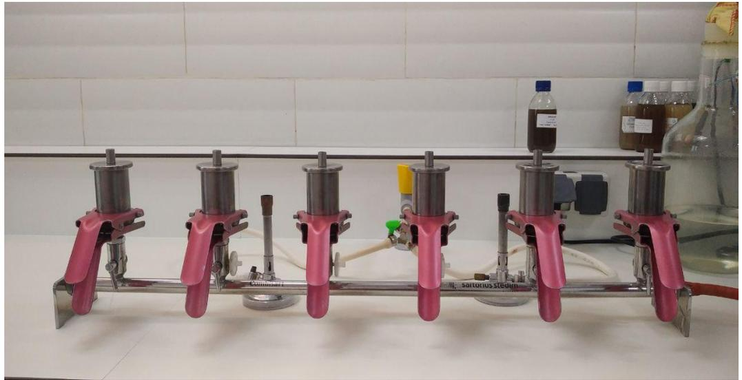
La rampe de filtration qui a été utilisée pour réaliser cette technique (original, 2024).
